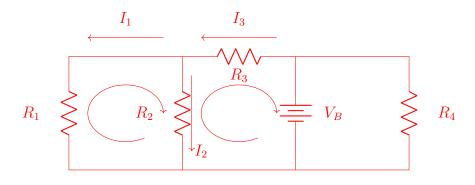
$$V_B - I_2 R_2 - I_3 R_3 = 0$$
